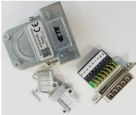
Die Stiftausführung SUB-D15M-Weber wurde speziell für den Ultraschallgenerator der Serie LC von Weber konzipiert. Der große Vorteil an der Ausführung liegt darin, dass eine einfache Konfektionierung durch die Federzugklemmen gegeben ist und diese unter Feldbedingungen stattfinden kann. Zusätzlich bietet das robuste Metallgehäuse die Möglichkeit, den Kabelschirm großflächig aufzulegen und gewährleistet so eine hohe Abschirmung gegen EMV-Störeinflüsse.
